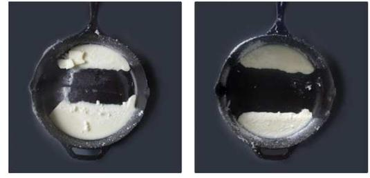
固形の植物性油に対して20bar/20cmの距離で中央部の除去比較テストを行いました。右の揺動ジェットノズルの方が綺麗に洗浄されている事がわかります。
